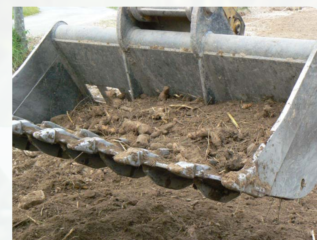
Figura 6. Extracción de rizomas mediante el cribado de sustrato con un cazo modificado.
